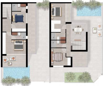
VIV 1. PLANTA PRIMERA CUADRO DE SUP. CONSTRUIDAS SUP. CONSTRUIDA PLANTA BAJA 72,05m<sup>2</sup> 49,50 m<sup>2</sup> SUPERFICIE CONSTRUIDA TOTAL SUP. CONTRUIDA 121,55 m² CUADRO DE SUP. EXTERIORES JARDÍN PISCINA TERRAZA - SOLARIUM TERRAZA PPAL 78,95 m² 9,50 m² 8,50 m² 3,55 m² TOTAL 100.50 m<sup>2</sup> SUPERFICIE DE PARCELA
